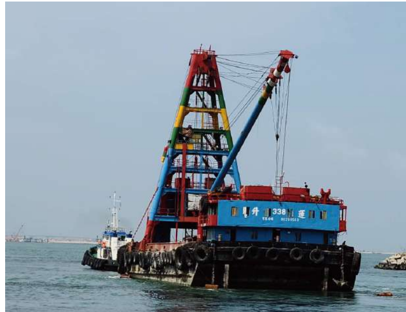
Derrick Lighter 橫雞趸 安全吊重40噸
