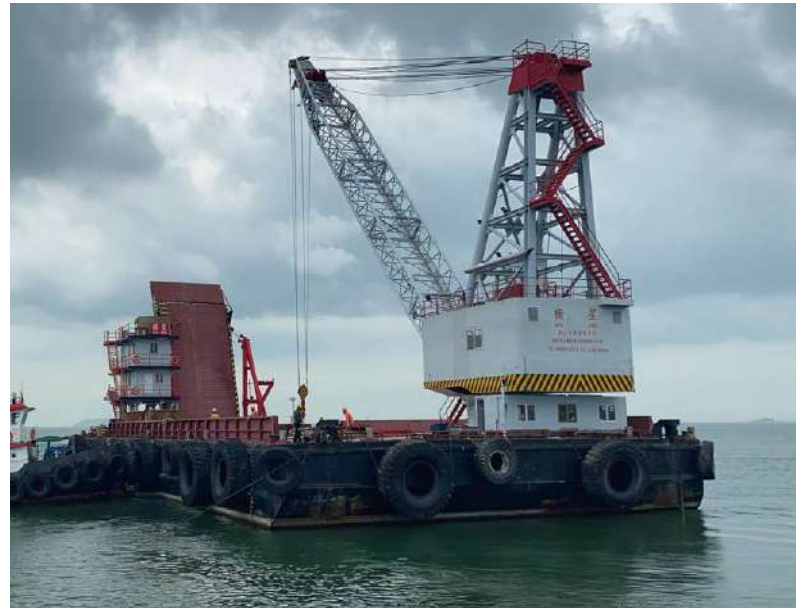
Crane Barge 吊趸 安全吊重120噸
